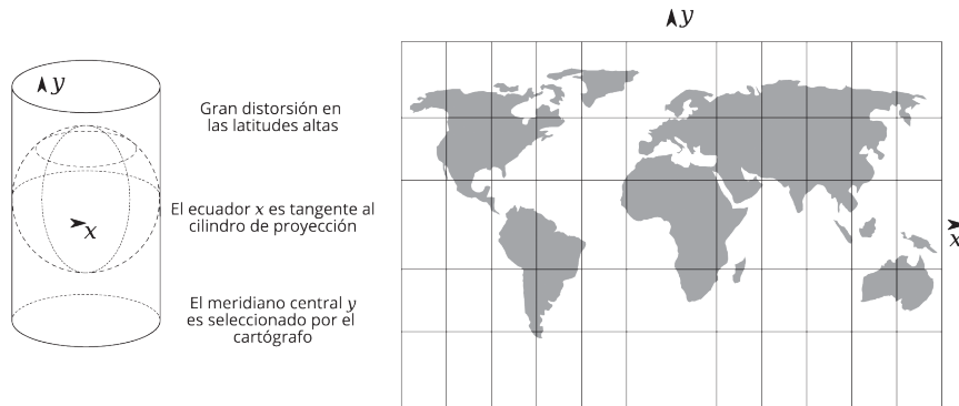
Figura 1. Explicación condensada de la proyección de Mercator
